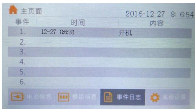
这个界面详细记录了本次充电过程的各项事件及其发生时刻，方便用户了解充电机在整个充电过程中充电机发生的各项操作及其输出状态。
