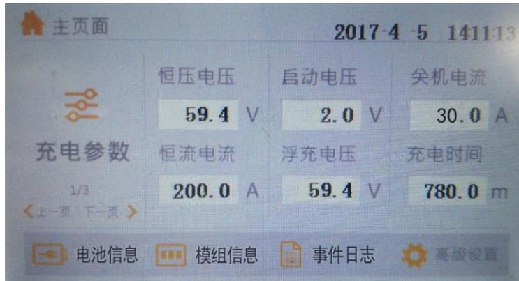
其中：恒流电流、恒压电压、充电时间等参数，同“设置参数显示”区域显示内容
